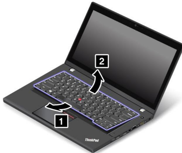
8. Legen Sie die Tastatur auf die Handablage und ziehen Sie die Stecker ab. Anschließend entfernen Sie die Tastatur.
