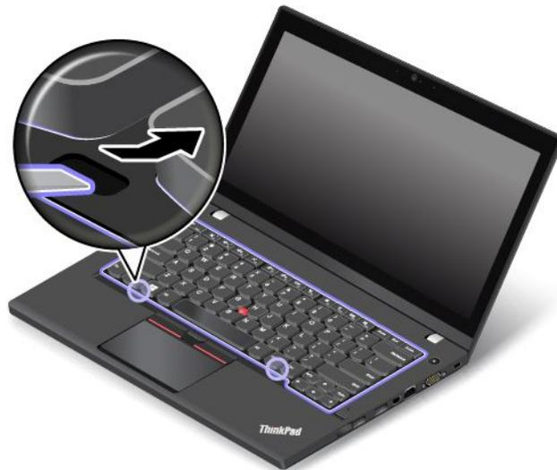
4. Ziehen Sie die Schrauben mit der Kreuzschlitzseite des Tastatur-Multifunktionswerkzeuges an, um die eingesetzte Tastatur zu sichern.
