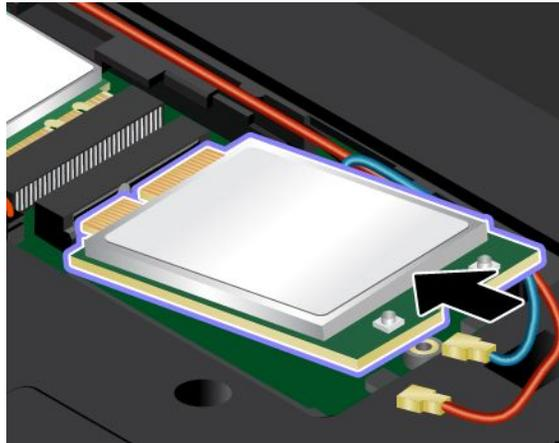
9. Klappen Sie die neue drahtlose WAN-Karte nach unten **1** und bringen Sie dann die Schraube an, um die Karte zu sichern **2**.
