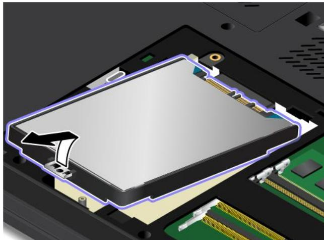
7. Installieren Sie das neue Festplattenlaufwerk oder Solid-State-Laufwerk.
