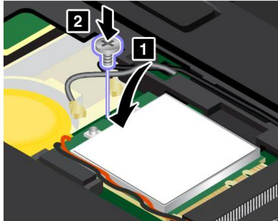
10. Schließen Sie die Antennenkabel an die Karte für drahtlose LAN-Verbindungen an. Stellen Sie sicher, dass das graue Kabel am Hauptanschluss der Karte für drahtlose LAN-Verbindungen und das schwarze Kabel am AUX-Anschluss der Karte angeschlossen ist.
