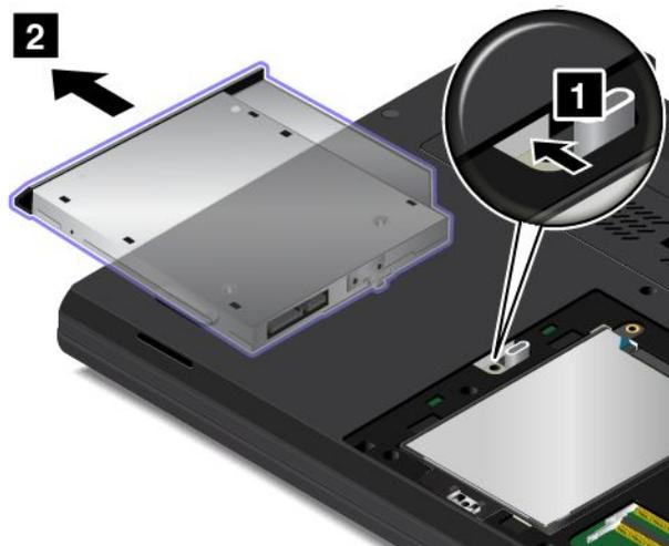
7. Setzen Sie die neue Ultrabay-Einheit in die Position.
