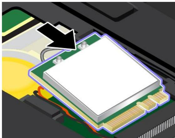
9. Klappen Sie die neue drahtlose LAN-Karte nach unten **1** und bringen Sie dann die Schraube an, um die Karte zu sichern **2**.
