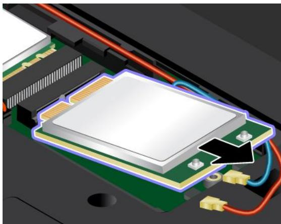
8. Richten Sie den Rand mit den Kontakten der neuen Karte für drahtlose WAN-Verbindungen mit der Einkerbung an der Aussparung des zugehörigen Steckplatzes aus. Setzen Sie dann die neue Karte für drahtlose WAN-Verbindungen vorsichtig in einem Winkel von ca. 20 Grad in den Steckplatz ein.
