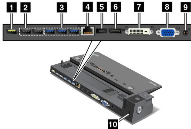
**1 Always-On USB-Anschluss:** Für die Verbindung von Einheiten, die mit USB 2.0 kompatibel sind, oder zum Aufladen einiger digitaler Mobileinheiten und Smartphones, wenn sich der Computer im Energiespar- oder Ruhemodus befindet oder ausgeschaltet ist.
