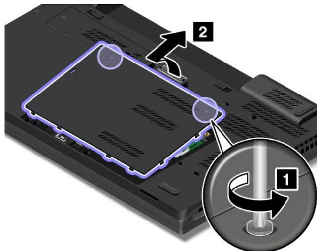
5. Entfernen Sie die Schraube, die zur Sicherung des Festplattenlaufwerks oder des Solid-State-Laufwerks dient.
