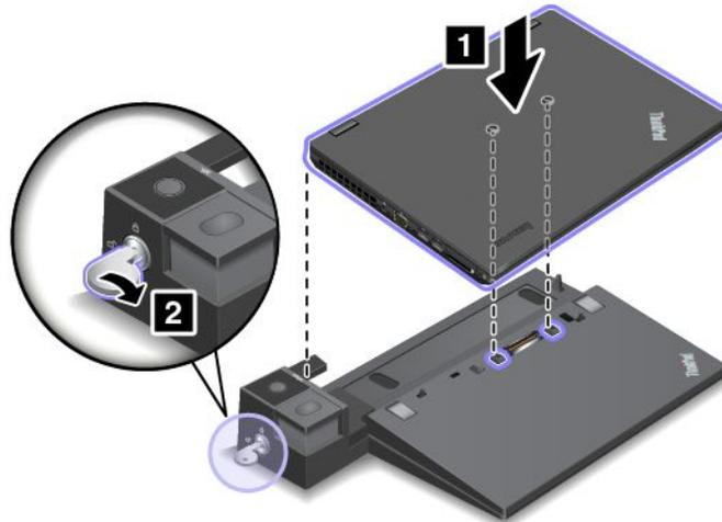
4. Überprüfen Sie die Andockstatusanzeige. Wenn die Andockstatusanzeige nicht aufleuchtet, wurde der Computer nicht ordnungsgemäß mit der Andockstation verbunden. Überprüfen Sie das Netzteil an der Andockstation oder ziehen Sie das Netzteil ab und schließen Sie es dann wieder an.
