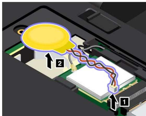
6. Setzen Sie die neue Knopfzellenbatterie **1** ein und schließen Sie dann den Stecker **2** an.
