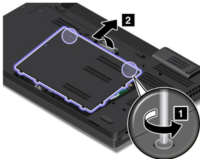
5. Entfernen Sie die Schraube, mit der die Ultrabay-Einheit gesichert ist.
