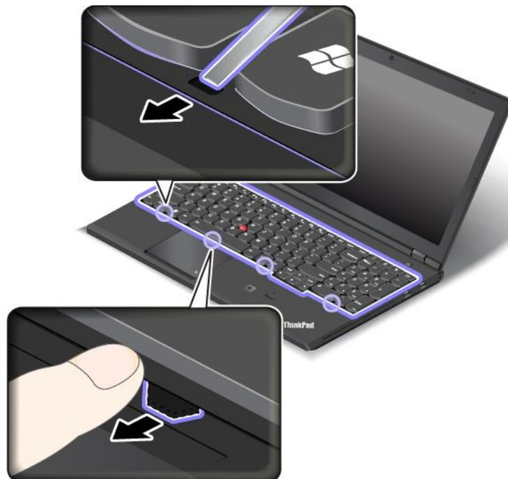
6. Passen Sie den eingesetzten Tastaturrahmen mit dem flachen Ende des Tastatur-Multifunktionswerkzeugs an und stellen Sie sicher, dass sämtliche Verriegelungen unter der Tastaturblende gesichert werden.
