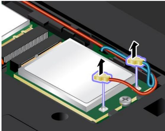
6. Entfernen Sie die Schraube. Die Karte für drahtlose WAN-Verbindungen wird aus der sicheren Stellung gelöst und dreht sich nach oben.
