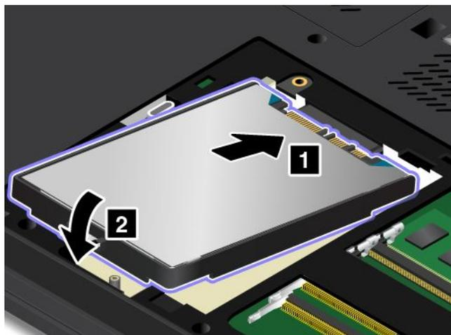
8. Bringen Sie die Schraube, die zur Sicherung des Festplattenlaufwerks oder des Solid-State-Laufwerks dient, wieder an.
