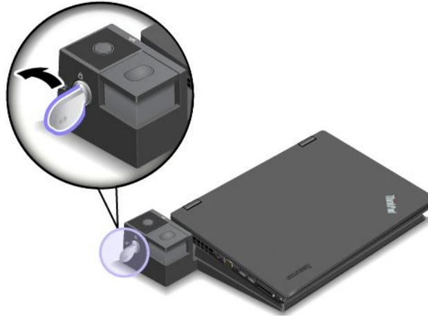
3. Drücken Sie die Entnahmetaste, bis sich der Computer nach oben bewegt. Halten Sie den Computer seitlich mit beiden Händen fest und entfernen Sie ihn.
