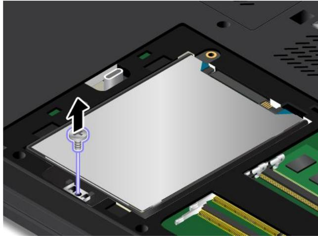
6. Entfernen Sie das Festplattenlaufwerk bzw. Solid-State-Laufwerk.
