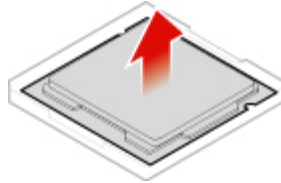
Abbildung 113. Mikroprozessorstecksocket nach oben drehen
