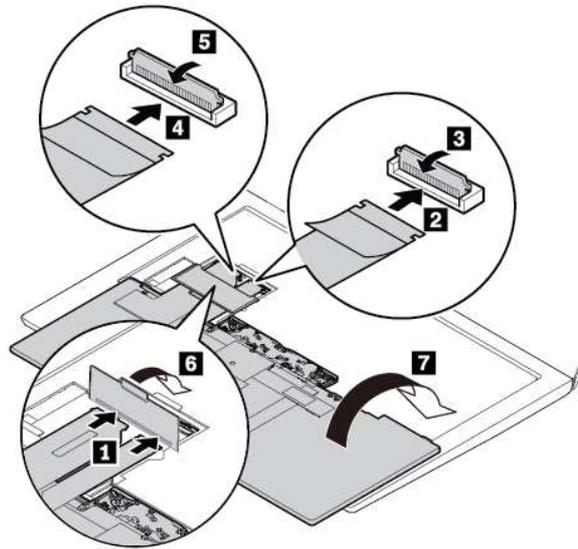
2. Setzen Sie die Tastatur wie abgebildet in die Tastaturblende ein. Stellen Sie sicher, dass sich der obere Rand der Tastatur (der zur Computeranzeige weisende Rand) unter dem Rahmen der Tastaturblende befindet.
