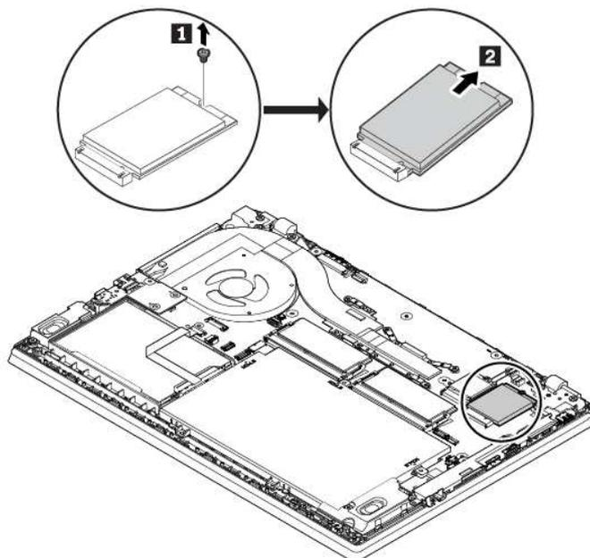
6. Gehen Sie wie folgt vor, um das neue M.2 Solid-State-Laufwerk zu installieren:
