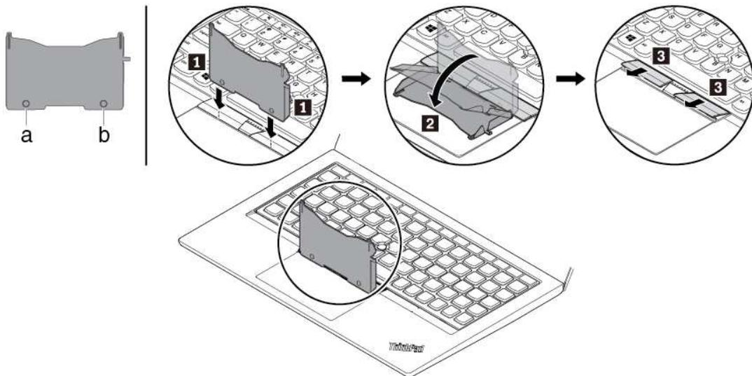
5. Lösen Sie die Schrauben, mit denen die Tastatur befestigt ist.
