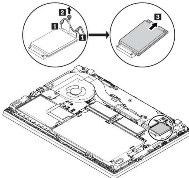
6. Installieren Sie eine neue Karte für drahtlose WAN-Verbindungen, indem Sie wie folgt vorgehen:
