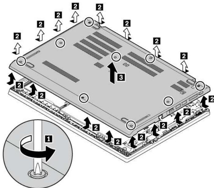
Abbildung 5. Baugruppe für die untere Abdeckung entfernen (für ThinkPad L580 Computer)
