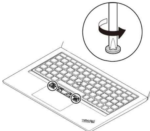
6. Setzen Sie die Laschen **c** und **d** wie dargestellt in die zwei Vertiefungen in der Nähe der beiden Schraubenköpfe ein.
