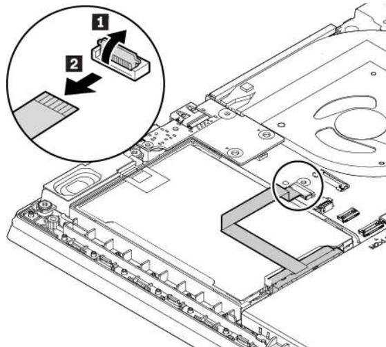
6. Ziehen Sie an der Lasche, um das Speicherlaufwerk zu entfernen.
