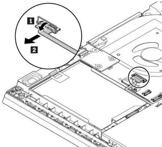
6. Ziehen Sie an der Lasche, um den Adapter des M.2 Solid-State-Laufwerks zu entfernen.
