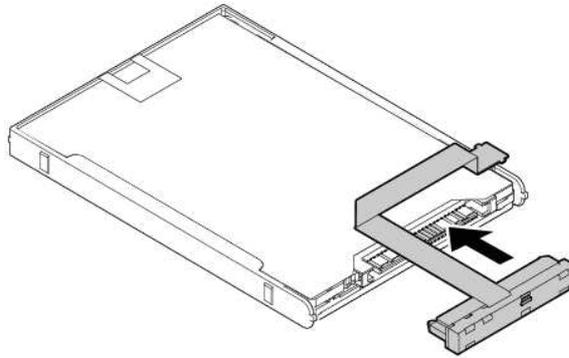
3. Setzen Sie das neue Speicherlaufwerk **1** ein und drehen Sie es nach unten **2**. Stellen Sie sicher, dass das neue Speicherlaufwerk eingerastet ist.
