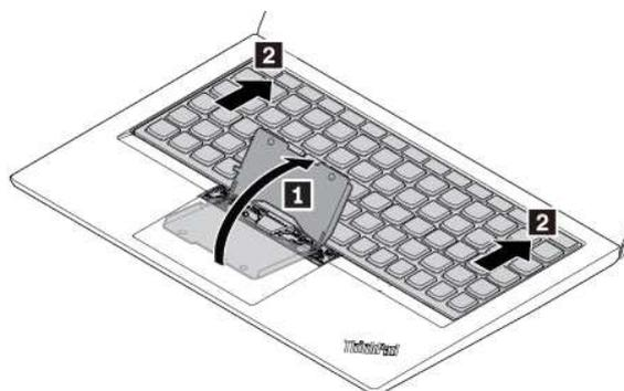
8. Schwenken Sie die Tastatur leicht nach oben, wie durch den Pfeil **1** dargestellt. Wenden Sie die Tastatur dann in die von Pfeil **2** angegebene Richtung.
