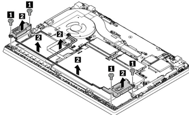
7. Installieren Sie die neue Lautsprechereinheit in Position **1** und verlegen Sie die Lautsprecherkabel. Bringen Sie dann die beiden Schrauben an, um die Lautsprechereinheit zu befestigen **2**.
