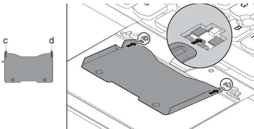
7. Drehen Sie das Werkzeug in die in der Abbildung dargestellte Richtung, um die Tastatur freizugeben **1**. Schieben Sie die Tastatur in die durch die Pfeile **2** gekennzeichnete Richtung, um die Verriegelungen von der Tastaturblende freizugeben.
