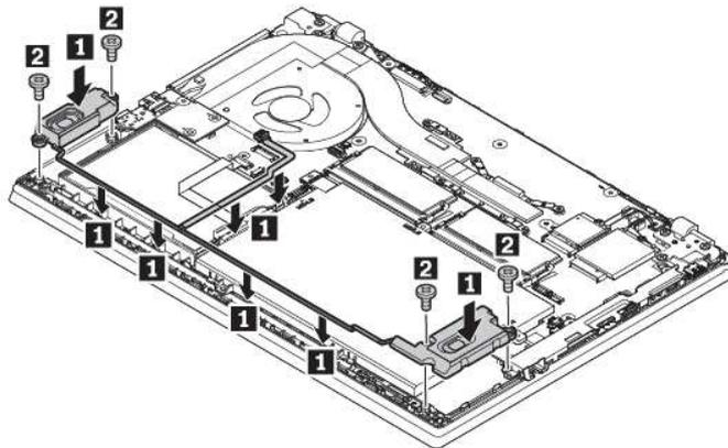
8. Schließen Sie den Anschluss der Lautsprechereinheit an.
