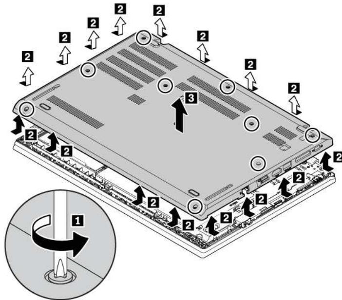
Abbildung 4. Baugruppe für die untere Abdeckung entfernen (für ThinkPad L480 Computer)
