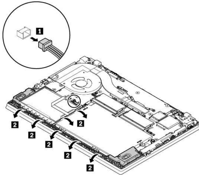
6. Entfernen Sie die Schrauben, mit denen die Lautsprechereinheit befestigt ist **1**, und entfernen Sie dann die Lautsprechereinheit **2**.
