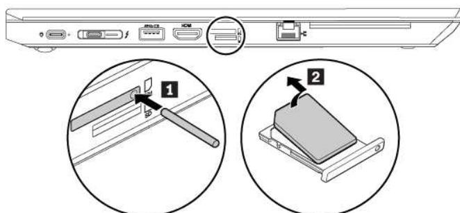
3. Setzen Sie eine neue Nano-SIM-Karte so in den Einschub ein, dass die Metallkontakte nach unten zeigen **1**. Setzen Sie den Einschub in den Nano-SIM-Kartensteckplatz ein, bis er hörbar einrastet **2**. Achten Sie darauf, die neue Nano-SIM-Karte richtig herum einzusetzen.
