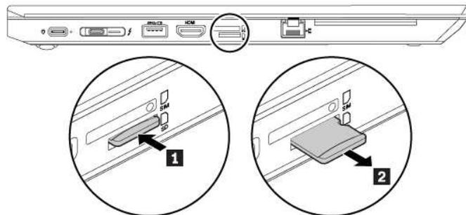
3. Setzen Sie die neue Karte in den microSD-Kartensteckplatz ein. Möglicherweise stoppt die Karte, bevor sie in das Lesegerät für Speicherkarten eingesetzt ist. Stellen Sie sicher, dass Sie die Karte fest in den Steckplatz einsetzen, bis sie hörbar einrastet.
