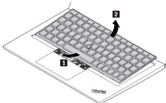
9. Legen Sie die Tastatur auf die Handablage, wie in der Abbildung dargestellt. Öffnen Sie die Kunststoffabdeckung und ziehen Sie die Anschlüsse ab. Anschließend entfernen Sie die Tastatur.
