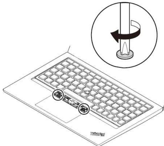
5. Nehmen Sie die neuen TrackPoint-Tasten aus der Verpackung der neuen Tastatur heraus. Setzen Sie die neuen TrackPoint-Tasten, wie dargestellt, ein.
