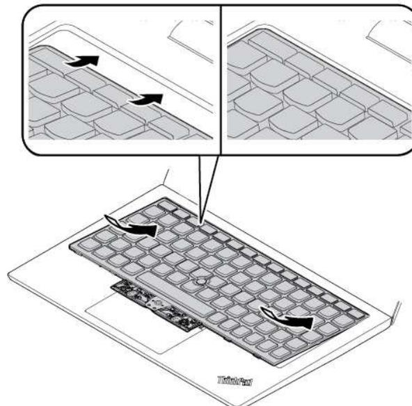
3. Schieben Sie die Tastatur in die durch die Pfeile angegebene Richtung. Vergewissern Sie sich, dass die Verriegelungen unter dem Tastaturrahmen gesichert sind.
