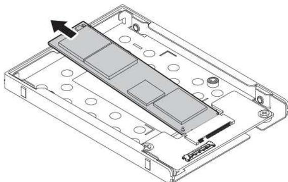
Gehen Sie wie folgt vor, um das M.2-Solid-State-Laufwerk zu installieren:
