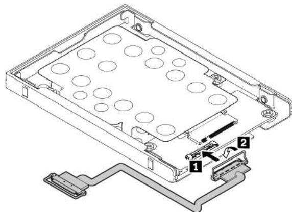
5. Setzen Sie den Adapter ein **1** und drehen Sie ihn dann nach unten **2**. Vergewissern Sie sich, dass der Adapter fest im Steckplatz sitzt.
