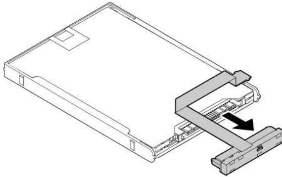
8. Entfernen Sie die Halterung des Speicherlaufwerks.
