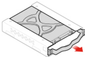
Abbildung 42. Das sekundäre 2,5-Zoll-Speicherlaufwerk aus der Halterung entfernen
