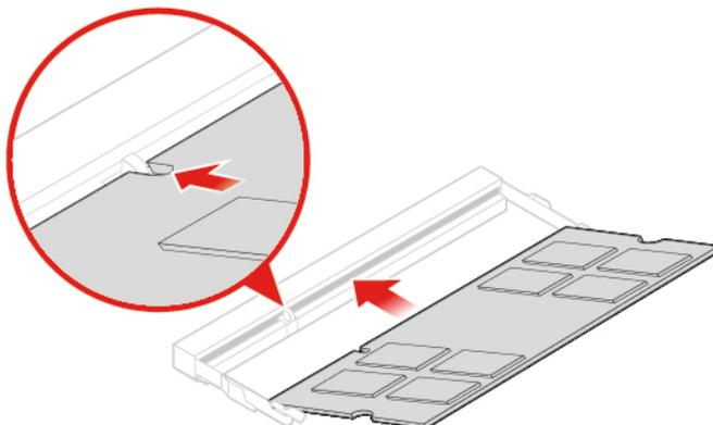
Abbildung 74. Speichermodul installieren
