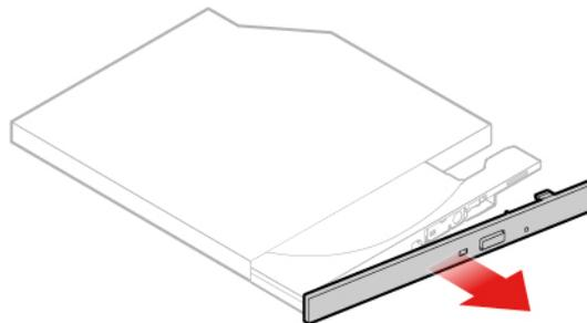
Abbildung 25. Blende des optischen Laufwerks entfernen
