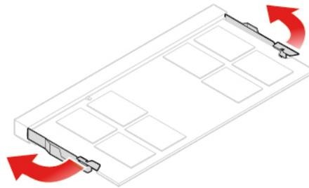
Abbildung 72. Verriegelungen entfernen
