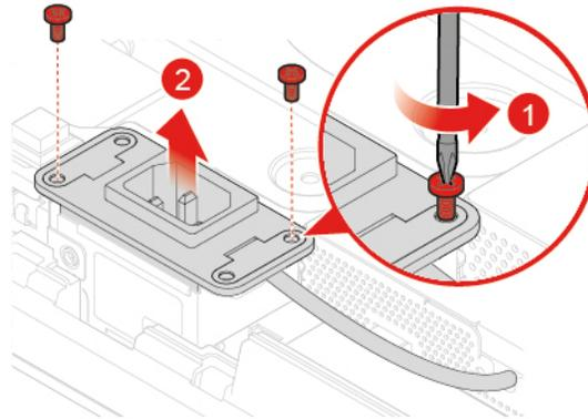
Abbildung 38. Netzkabel-Anschluss entfernen
