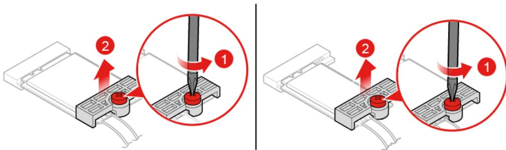
Abbildung 56. Abdeckung der Wi-Fi-Karte entfernen
