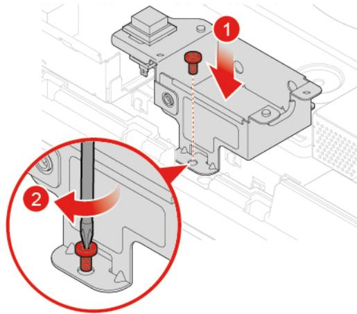
Abbildung 45. Schalter zur Abdeckungserkennung und die Halterung installieren
