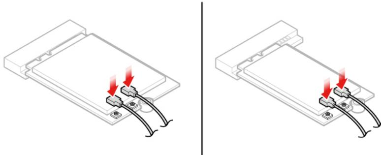
Abbildung 60. Wi-Fi-Antennenkabel anschließen
