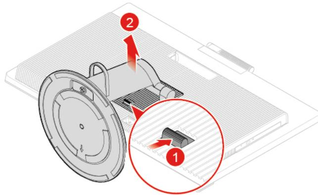
Abbildung 13. Mit allen Funktionen ausgestatteten Bildschirmständer entfernen
