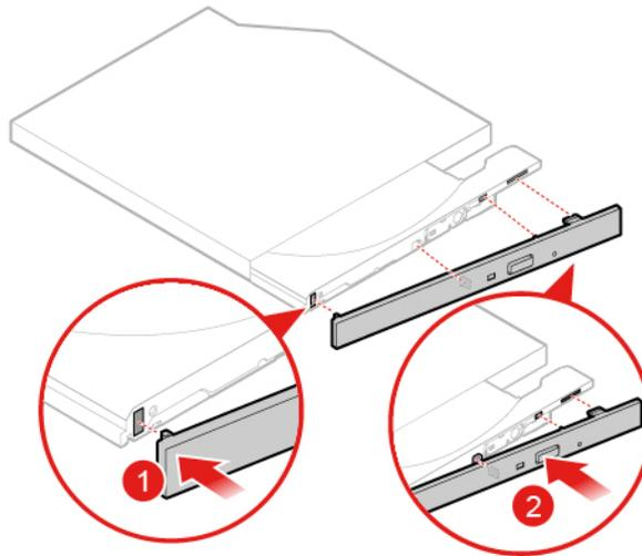
Abbildung 26. Blende für das optische Laufwerk installieren
