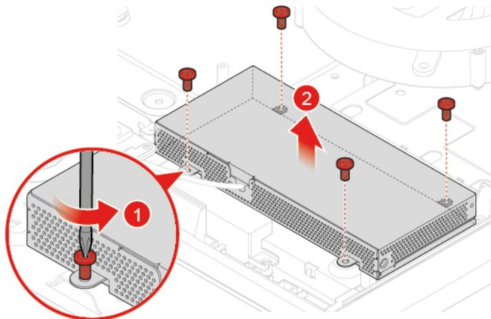
Abbildung 39. Netzteil entfernen
