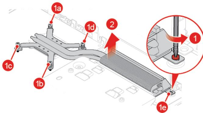
Abbildung 48. Kühlkörper entfernen
