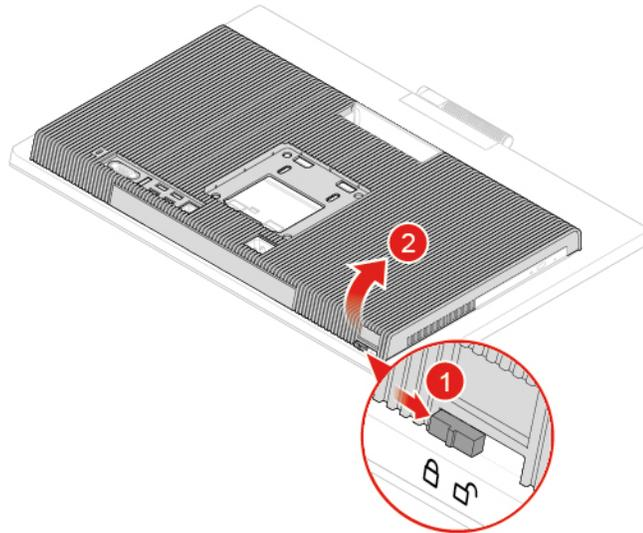
Abbildung 17. Computerabdeckung entfernen
