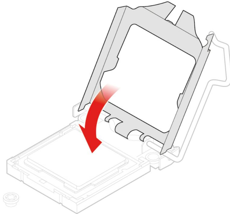
Abbildung 54. Halterung schließen
