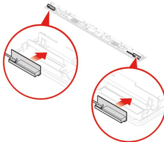
Abbildung 99. Wi-Fi-Antennen installieren
