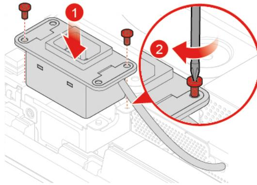
Abbildung 41. Netzkabel-Anschluss installieren
