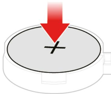
Abbildung 79. Knopfzellenbatterie mit der Verriegelung befestigen
