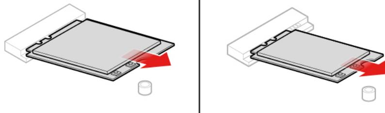
Abbildung 58. Wi-Fi-Karte entfernen
