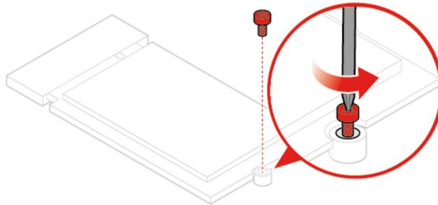
Abbildung 68. Schraube entfernen
