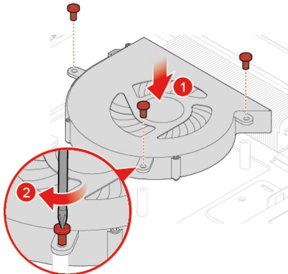
Abbildung 47. Systemlüfter installieren
