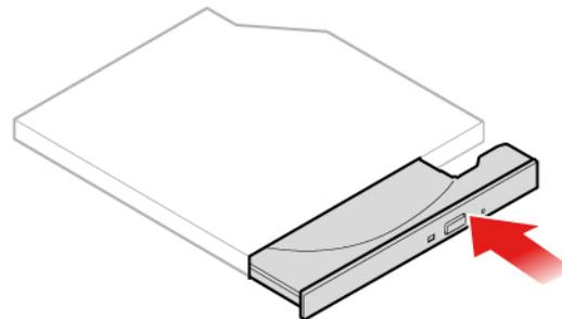
Abbildung 27. Laufwerkschlitten schließen
