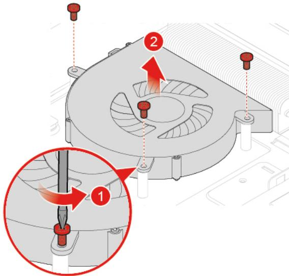
Abbildung 46. Systemlüfter entfernen
