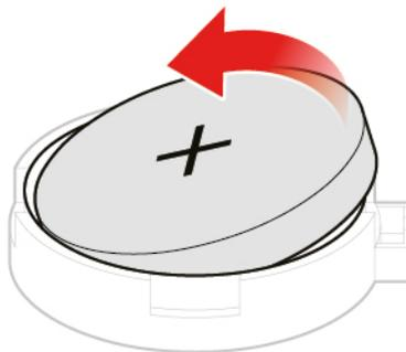
Abbildung 77. Knopfzellenbatterie entfernen
