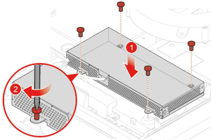
Abbildung 40. Netzteil installieren
