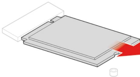
Abbildung 69. M.2-Solid-State-Laufwerk entfernen
