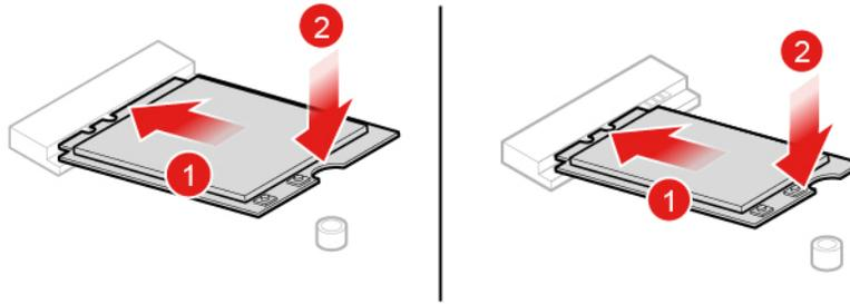
Abbildung 59. Wi-Fi-Karte installieren
