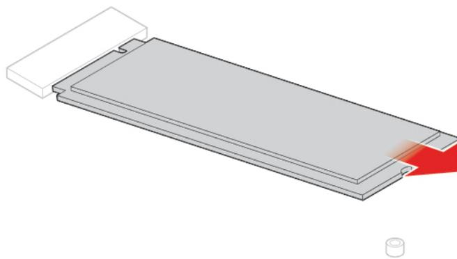
Abbildung 65. M.2-Solid-State-Laufwerk entfernen
