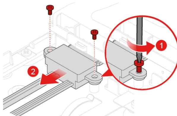
Abbildung 30. Kabel für optisches Laufwerk und Speicher-Laufwerke entfernen
