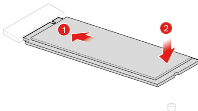
Abbildung 66. M.2-Solid-State-Laufwerk installieren
