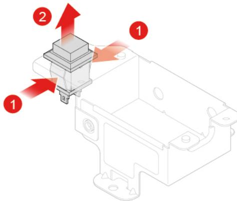
Abbildung 43. Schalter zur Abdeckungserkennung aus der Halterung entfernen
