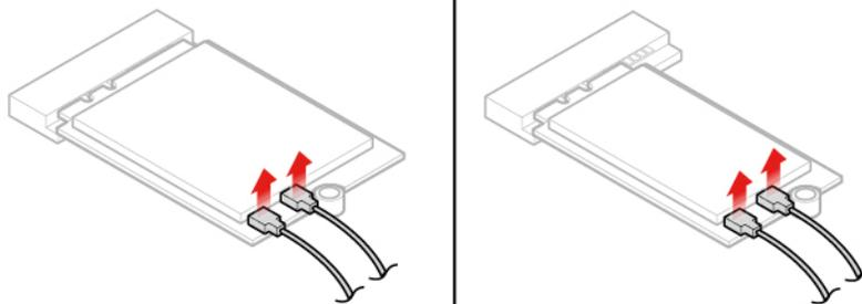
Abbildung 57. Wi-Fi-Antennenkabel entfernen
