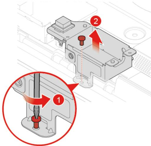
Abbildung 42. Schalter zur Abdeckungserkennung und die Halterung entfernen
