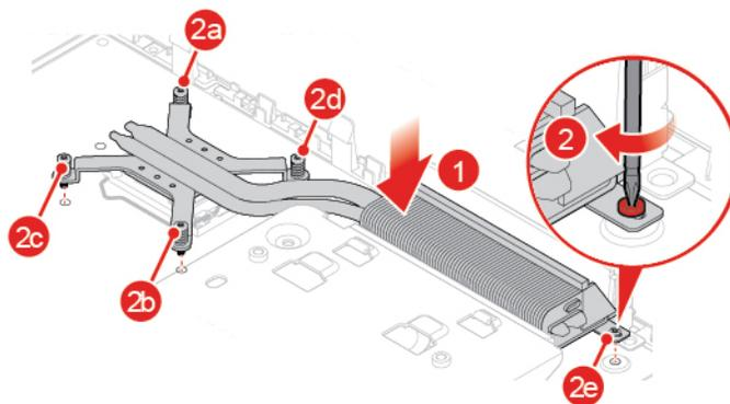
Abbildung 49. Kühlkörper installieren
