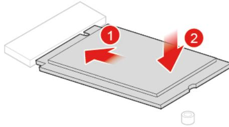
Abbildung 70. M.2-Solid-State-Laufwerk installieren
