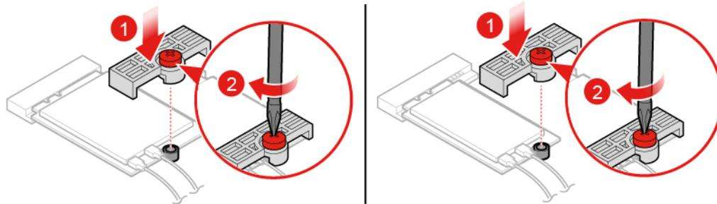
Abbildung 61. Abdeckung der Wi-Fi-Karte installieren
