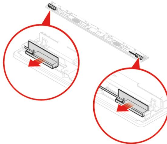
Abbildung 98. Wi-Fi-Antennen entfernen
