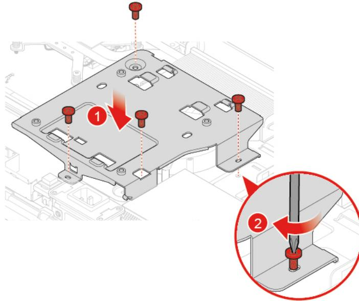
Abbildung 37. VESA-Halterung installieren
