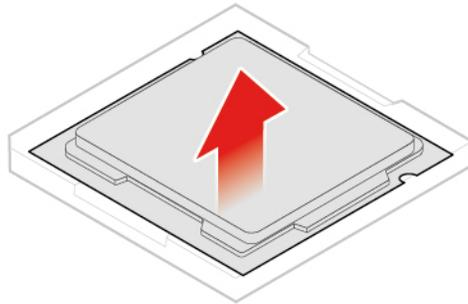
Abbildung 52. Mikroprozessor entfernen
