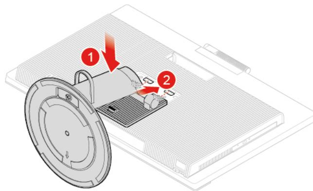
Abbildung 14. Mit allen Funktionen ausgestatteten Bildschirmständer anbringen
