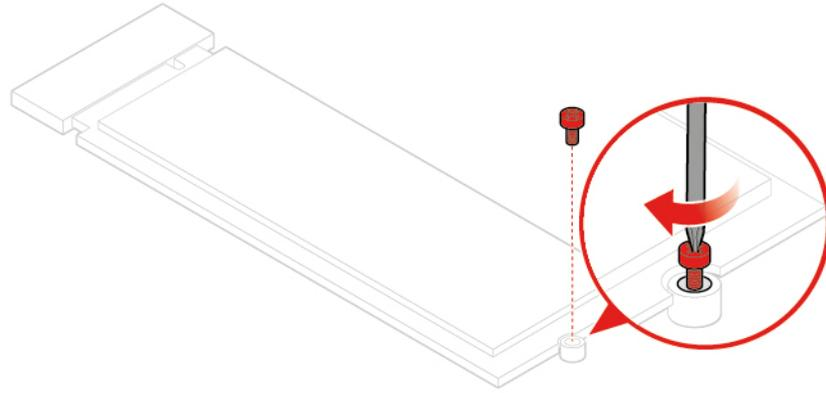
Abbildung 67. Schraube installieren
