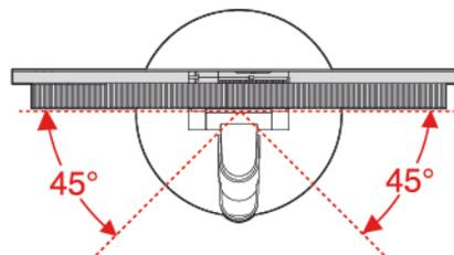
Abbildung 7. Bildschirm nach links und nach rechts drehen
