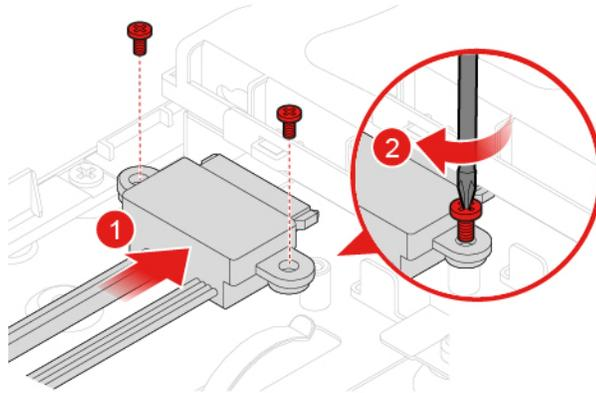
Abbildung 31. Kabel für optisches Laufwerk und Speicher-Laufwerke installieren
