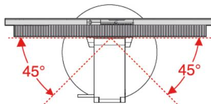
Abbildung 10. Bildschirm nach links und nach rechts drehen
