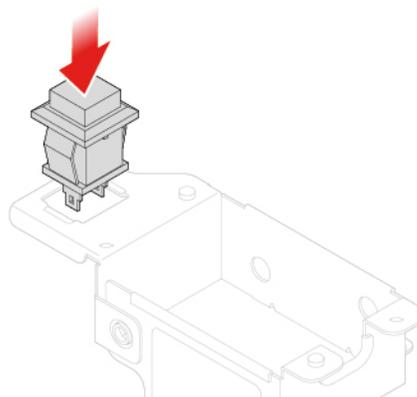
Abbildung 44. Schalter zur Abdeckungserkennung in der Halterung installieren
