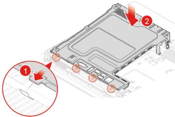
Abbildung 35. Installieren der Systemplattenabdeckung
