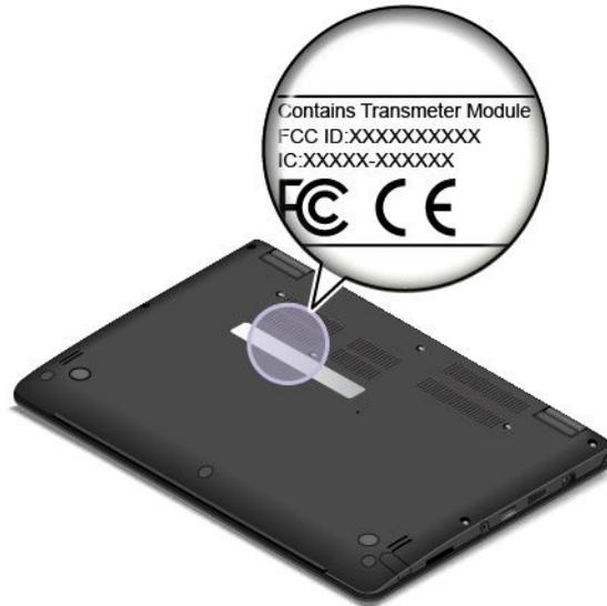
Bei einem vorinstallierten drahtlosen Modul identifiziert dieses Etikett die tatsächliche FCC-Kennung und IC-Zertifizierungsnummer für das drahtlose Modul, das von Lenovo installiert wurde.
