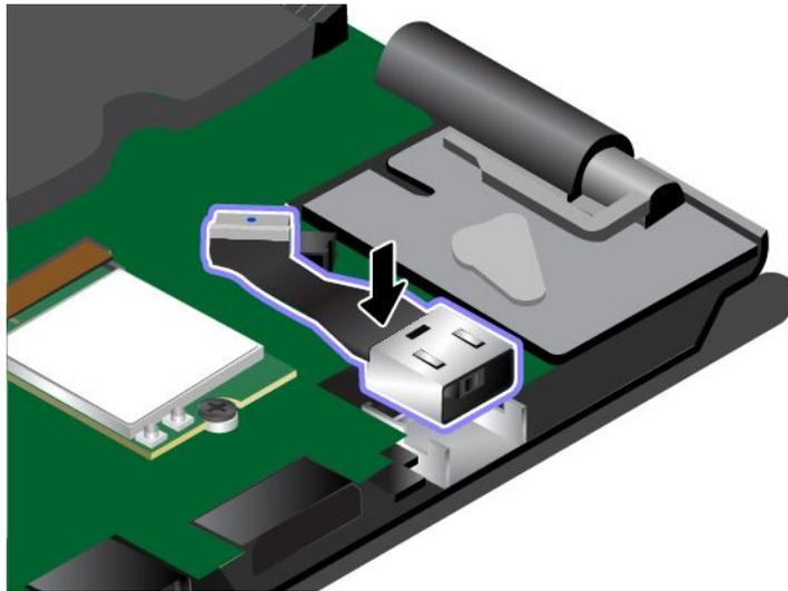
9. Installieren Sie die Netzeingangshalterung an der entsprechenden Position.
