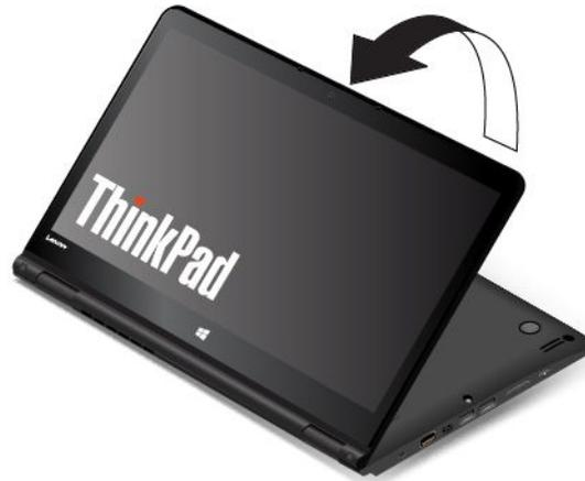
2. Den Computer wie abgebildet positionieren. Der Computer befindet sich nun im Zeltmodus.
