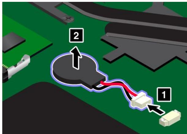
5. Setzen Sie die neue Knopfzellenbatterie **1** ein und schließen Sie dann den Stecker **2** an.
