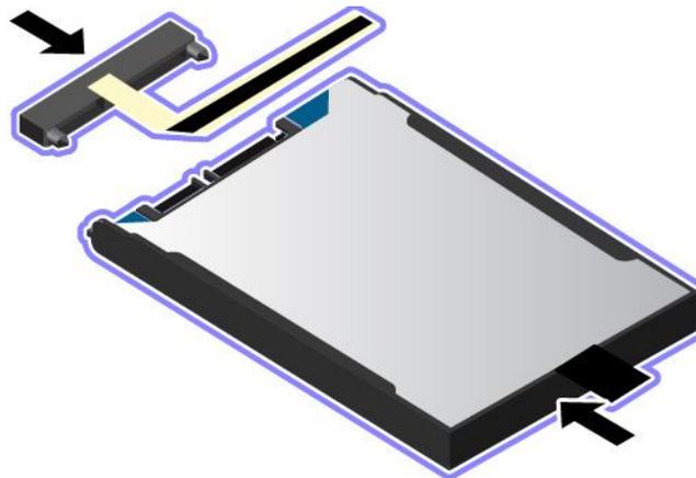
8. Setzen Sie das neue Laufwerk in die Laufwerkposition ein.
