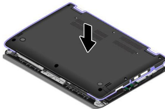
7. Ziehen Sie die Schrauben fest, um die Baugruppe für die untere Abdeckung zu fixieren.
