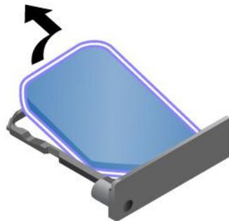
5. Setzen Sie die neue Micro-SIM-Karte in den Mikro-SIM-Karteneinschub ein.
