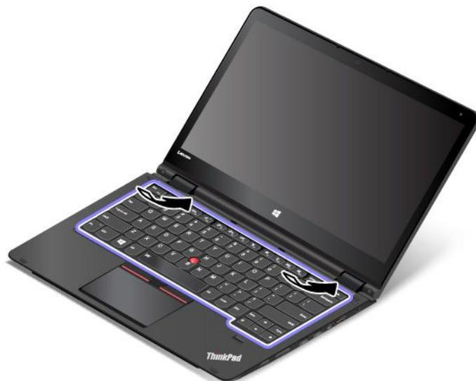
3. Schieben Sie die Tastatur in die von den Pfeilen angegebene Richtung, bis sich die Verriegelungen des Tastaturrahmens unter der Tastaturblende befinden.
