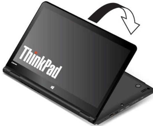
2. Den Computer wie abgebildet positionieren. Der Computer befindet sich jetzt im Tabletmodus. Die automatische Bildschirmdrehung ist standardmäßig aktiviert.
