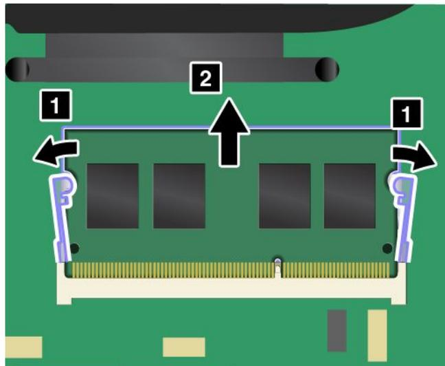
5. Setzen Sie das neue Speichermodul so ein, dass das eingekerbte Ende zur Kontaktseite des Speichersteckplatzes zeigt. Setzen Sie das Speichermodul in einem Winkel von etwa 20 Grad in den Speichersteckplatz ein **1**. Klappen Sie das Speichermodul nach unten, bis es hörbar einrastet **2**. Stellen Sie sicher, dass das Speichermodul fest im Speichersteckplatz installiert ist und nur schwer bewegt werden kann.
