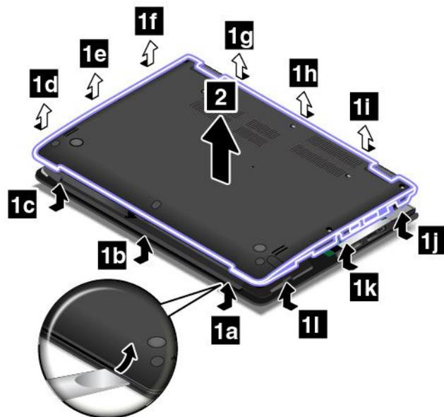
6. Montieren Sie die Baugruppe für die untere Abdeckung an der entsprechenden Position.
