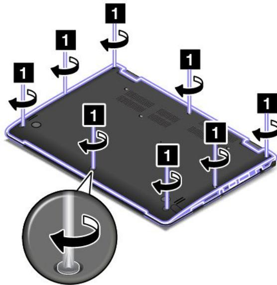
8. Setzen Sie die Schraube **1** und die Schraubkappen **2** wieder ein.
