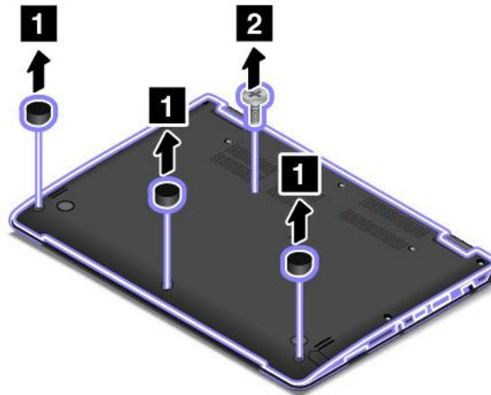
4. Lösen Sie die übrigen Schrauben, mit denen die Baugruppe für die untere Abdeckung gesichert ist.
