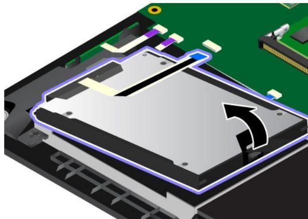
6. Ziehen Sie das Laufwerkabel vom Speicherlaufwerk ab.
