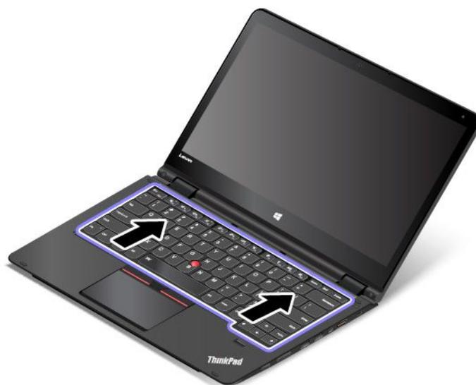
6. Schwenken Sie die Tastatur leicht nach oben, wie durch den Pfeil **1** dargestellt. Wenden Sie die Tastatur dann in die von Pfeil **2** angegebene Richtung.
