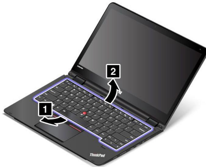
7. Ziehen Sie die Anschlüsse ab, und entfernen Sie die Tastatur.
