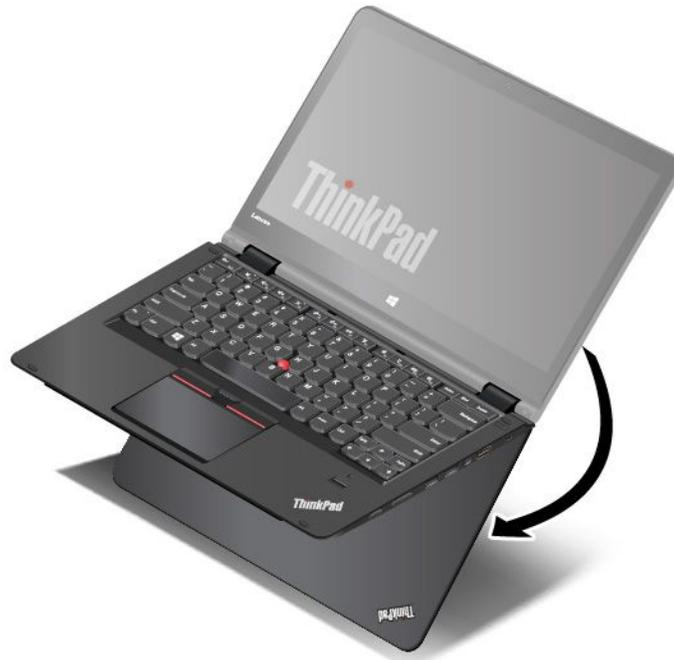
2. Den Computer wie abgebildet positionieren. Der Computer befindet sich nun im Standmodus.
