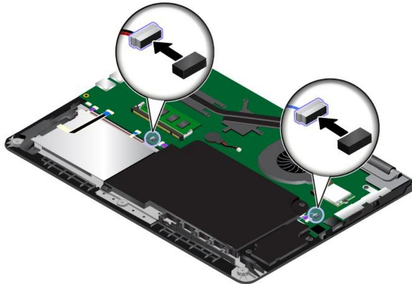
6. Entfernen Sie die Schrauben. Entfernen Sie danach die Lautsprechereinheit.
