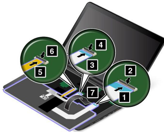
2. Setzen Sie die Tastatur in der von den Pfeilen angezeigten Richtung ein. Stellen Sie sicher, dass sich die hintere Kante der Tastatur (die zur Computeranzeige weisende Kante) unter dem Rahmen der Tastaturblende befindet.
