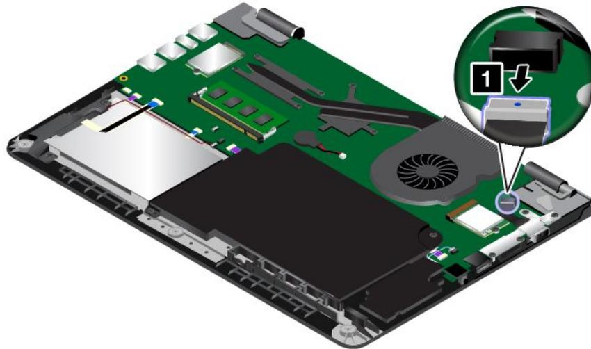
5. Entfernen Sie die Schrauben, mit denen die Netzkarte befestigt ist.
