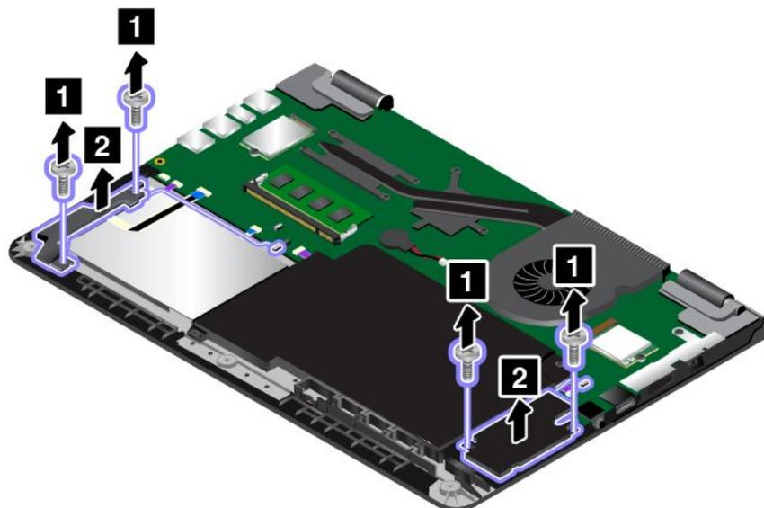
7. Montieren Sie die neue Lautsprechereinheit an der entsprechenden Position. Bringen Sie dann die beiden Schrauben an, um die Lautsprechereinheit zu befestigen.
