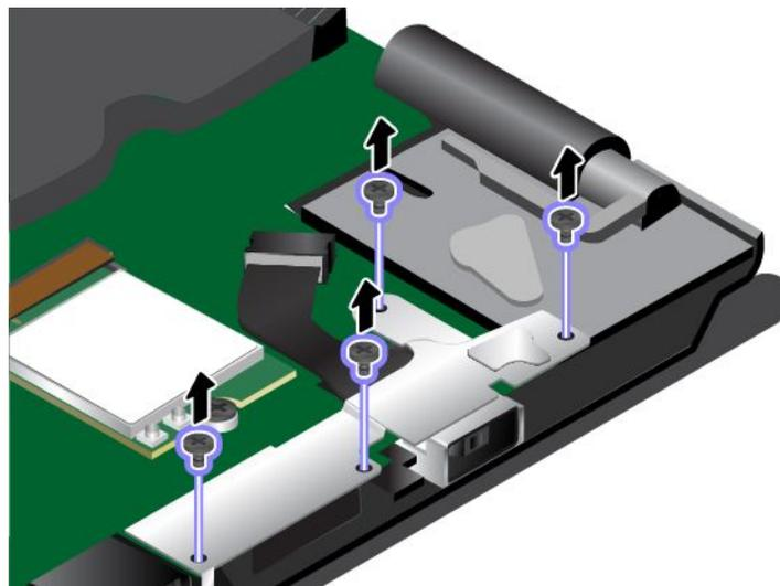
6. Entfernen Sie die Netzeingangshalterung.
