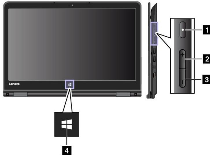
**1 Netzschalter:** Drücken Sie den Netzschalter, um den Computer einzuschalten.
