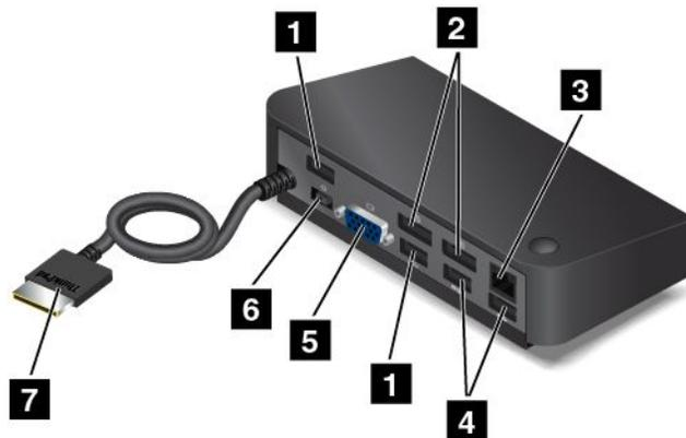
**1 USB 2.0-Anschlüsse:** Wird zum Anschließen von USB-Geräten verwendet, die mit USB 2.0 kompatibel sind.
