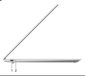
1. Netzteilanschluss/Thunderbolt $^{\text{\tiny TM}}$  4-Anschluss
