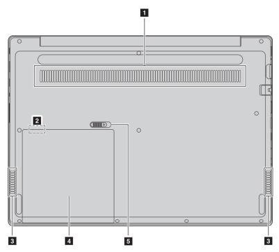
1 Belüftungsschlitze Leiten Wärme ab.
