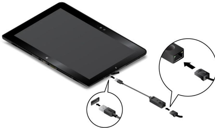
Der ThinkPad USB 3.0 Ethernet Adapter verfügt über zwei Netzwerk-Statusanzeigen. Wenn die grüne Anzeige leuchtet, ist das Tablet mit einem LAN verbunden. Wenn die Anzeige gelb blinkt, werden gerade Daten übertragen.
