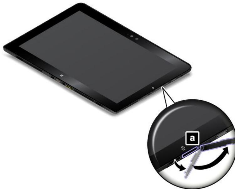
3. Halten Sie die Micro-SIM-Karte so, dass die Metallkontakte nach unten zeigen, und setzen Sie sie fest in den Micro-SIM-Karten-Steckplatz ein, bis sie hörbar einrastet.
