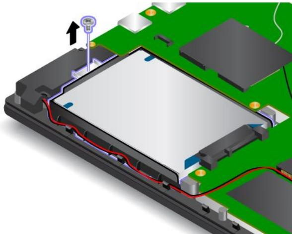
8. Entfernen Sie das Speicherlaufwerk.
