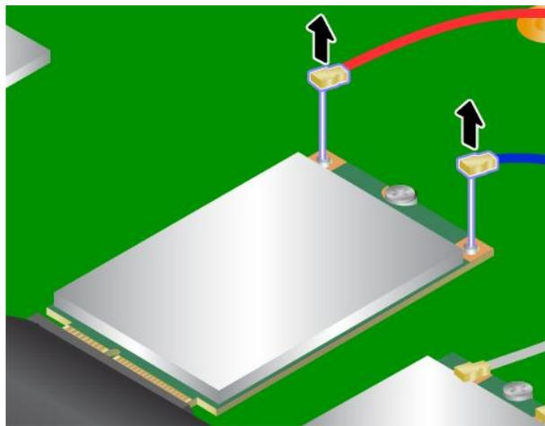
9. Entfernen Sie die Schraube. Die Karte wird nach oben gedrückt.
