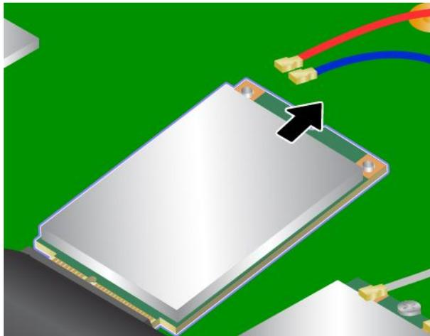
11. Setzen Sie die Kontaktleiste der neuen Karte so ein, dass sie am entsprechenden Steckplatz ausgerichtet ist **1**. Drehen Sie die neue Karte nach unten **2**.
