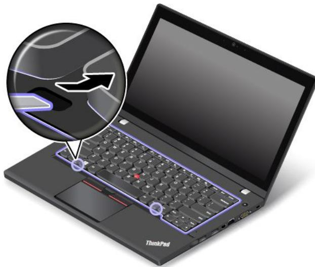
7. Lösen Sie die Schrauben mit der Kreuzschlitzseite des Tastatur-Multifunktionswerkzeugs.
