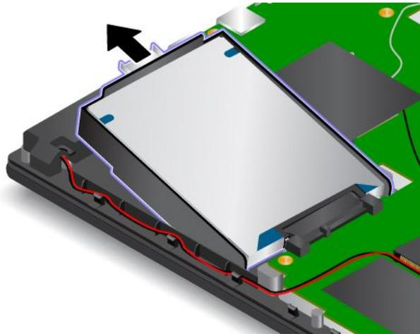
9. Setzen Sie das neue Speicherlaufwerk in die Laufwerkposition ein.
