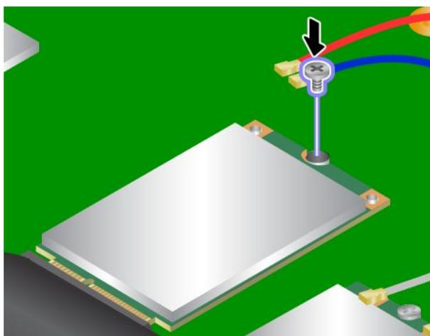
13. Schließen Sie die Antenne wie dargestellt an die neue Karte an. Lösen Sie nun die Hand, die die Schutzfolie hält.
