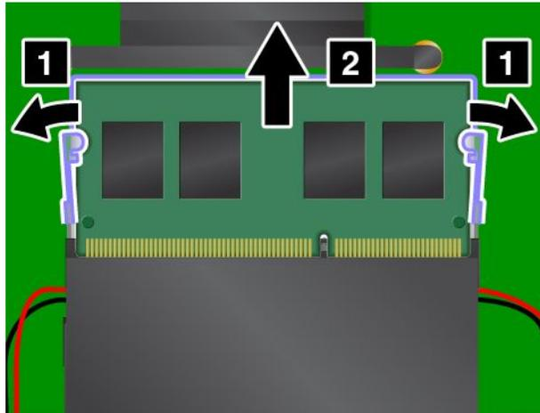
9. Setzen Sie das neue Speichermodul so ein, dass das eingekerbte Ende zur Kontaktseite des Speichersteckplatzes zeigt. Setzen Sie das Speichermodul **1** in einem Winkel von etwa 20 Grad in den Steckplatz ein. Klappen Sie das Speichermodul nach unten, bis es hörbar einrastet **2**. Stellen Sie sicher, dass das Speichermodul fest im Steckplatz installiert ist und nur schwer bewegt werden kann. Lösen Sie nun die Hand, die die Schutzfolie hält.
