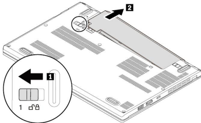
5. Entriegeln Sie die Akkuverriegelung **1** rechts. Ziehen Sie den Akku aus der unteren Abdeckung rechts, wie durch den Pfeil vorgegeben **2**.
