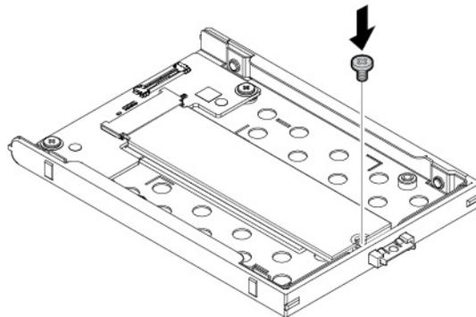
13. Bringen Sie die Halterung des M.2-Solid-State-Laufwerks an, und befestigen Sie sie mit den Schrauben.
