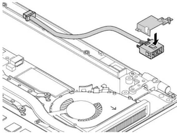
9. Installieren Sie das Netzeingangskabel mit der Halterung wie in der Abbildung dargestellt.
