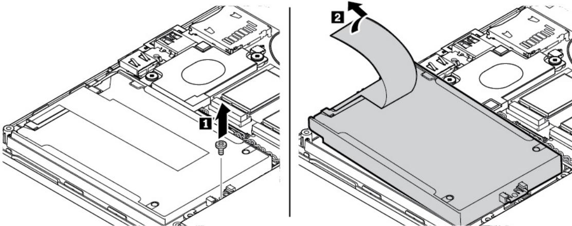
7. Ziehen Sie das Laufwerkkabel wie in der Abbildung dargestellt ab.
