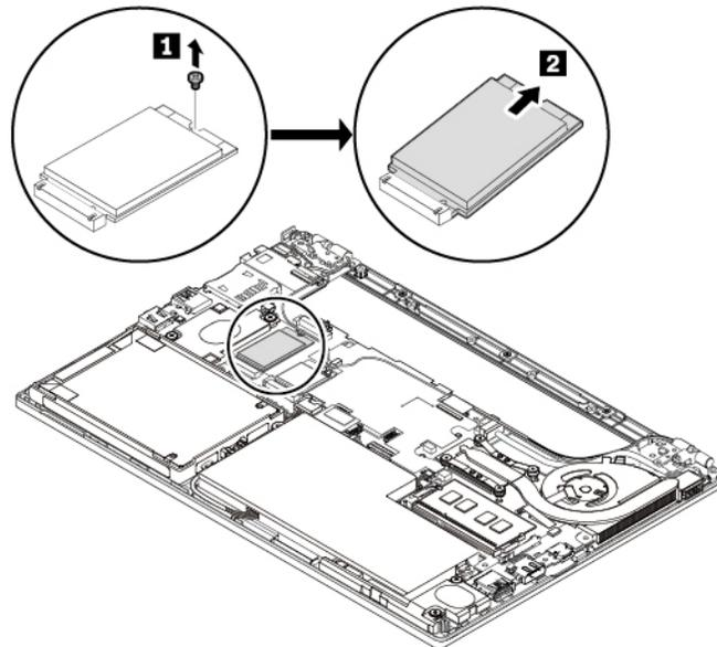
7. Richten Sie die Kerbe des neuen M.2-Solid-State-Laufwerks an der Aussparung des Steckplatzes aus. Setzen Sie das Laufwerk vorsichtig in einem Winkel von ca. 20 Grad in den Steckplatz ein, und drehen Sie es nach unten. Bringen Sie anschließend die Schraube an, um das Laufwerk zu befestigen.
