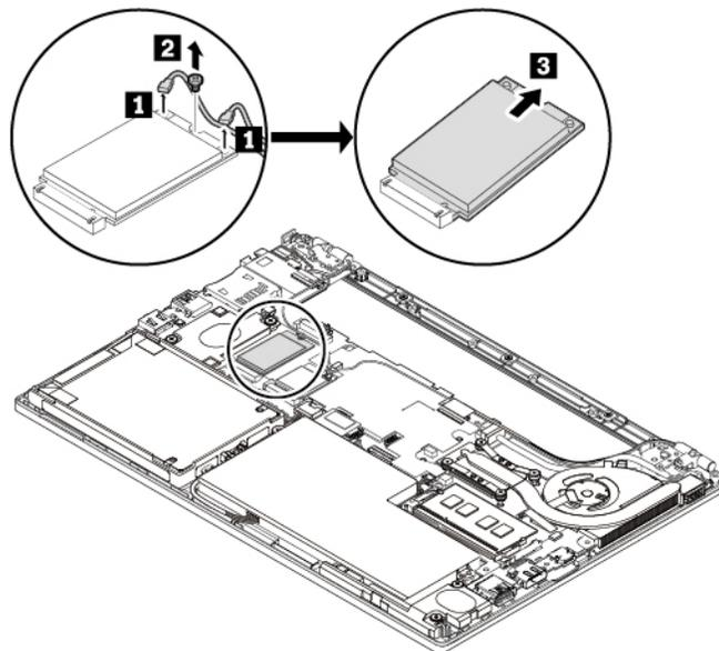
7. Installieren Sie eine neue Karte für drahtlose WAN-Verbindungen, indem Sie wie folgt vorgehen:
