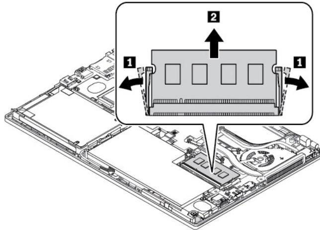
7. Setzen Sie das neue Speichermodul so ein, dass das eingekerbte Ende zur Kontaktseite des Speichersteckplatzes zeigt. Setzen Sie das neue Speichermodul in einem Winkel von etwa 20 Grad in den Speichersteckplatz ein **1**. Klappen Sie das Speichermodul nach unten, bis es hörbar einrastet **2**. Stellen Sie sicher, dass das Speichermodul fest im Speichersteckplatz installiert ist und nur schwer bewegt werden kann.
