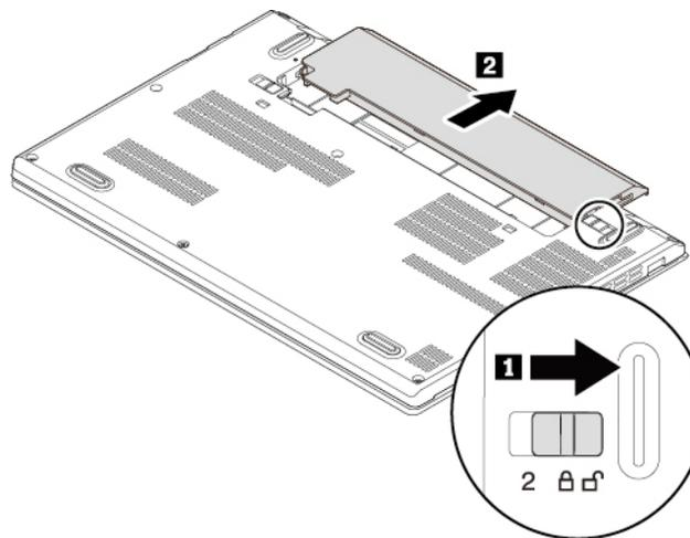
6. Setzen Sie einen neuen Akku so ein, dass er hörbar einrastet. Stellen Sie sicher, dass sich die Akkuverriegelungen in der gesperrten Position befinden.
