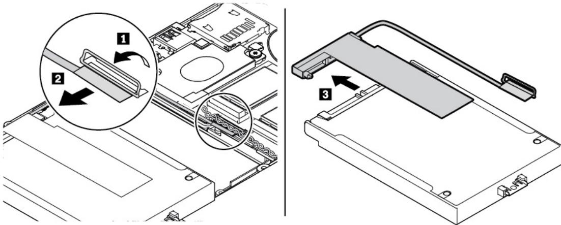
8. Schließen Sie das Laufwerkskabel an ein neues Laufwerk wie in der Abbildung dargestellt an.
