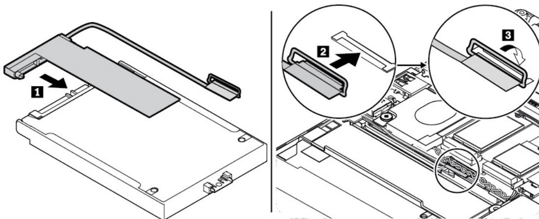
9. Setzen Sie das neue Speicherlaufwerk **1** ein und pivotieren Sie es nach unten **2**. Stellen Sie sicher, dass das Kabel unter dem Lautsprecherhook **3** verlegt ist, und ziehen Sie die Schraube an, um das Speicherlaufwerk zu sichern **4**.
