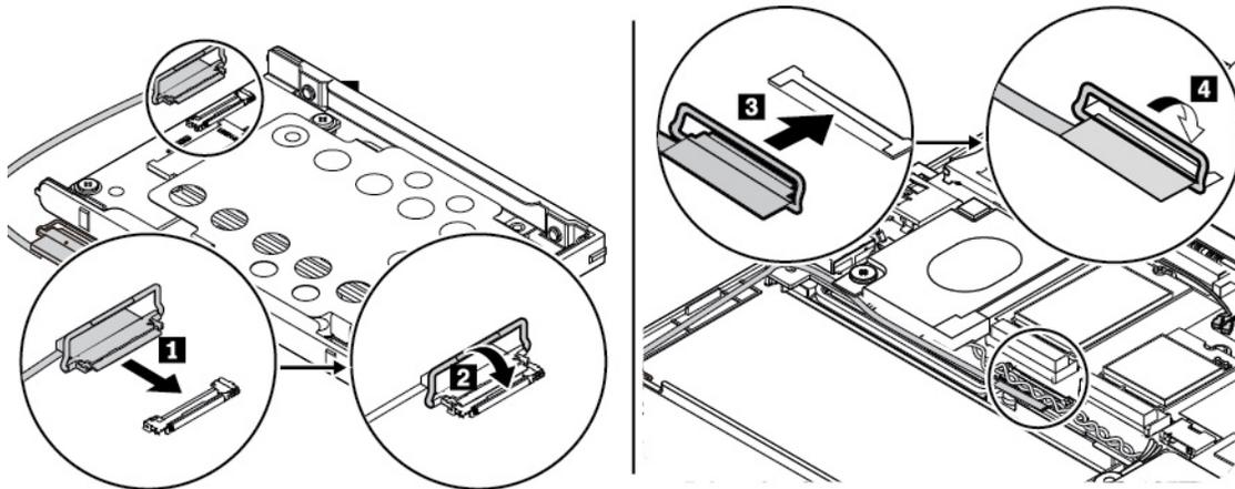
15. Setzen Sie das neue Speicherlaufwerk **1** ein und pivotieren Sie es nach unten **2**. Stellen Sie sicher, dass das Kabel unter dem Lautsprecherhook **3** verlegt ist, und ziehen Sie die Schraube an, um das Speicherlaufwerk zu sichern **4**.
