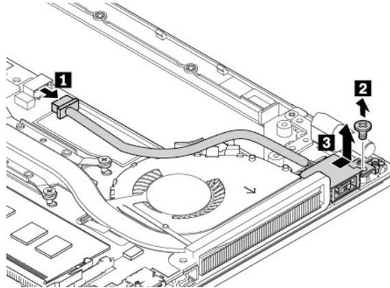
7. Entnehmen Sie das Netzeingangskabel aus der Halterung.
