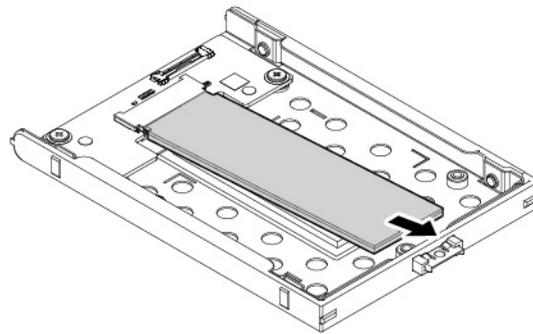
11. Richten Sie die Kerbe auf dem neuen M.2-Solid-State-Laufwerk an der Aussparung des Steckplatzes aus, und setzen Sie das Laufwerk in den Steckplatz ein, bis es fest sitzt **1**. Drehen Sie es dann nach unten **2**.
