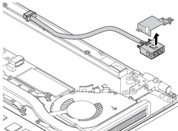
8. Installieren Sie ein neues Netzeingangskabel in der Halterung.
