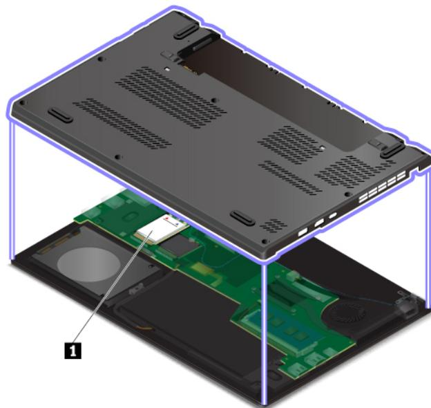
**Anmerkung:** Stellen Sie für das durch den Benutzer installierbare Modul sicher, dass Sie nur ein von Lenovo autorisiertes drahtloses Modul für den Computer verwenden. Andernfalls werden beim Einschalten des Computers eine Fehlermeldung angezeigt und akustische Signaltöne ausgegeben.
