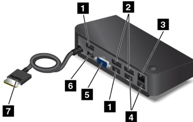
**1 USB 2.0-Anschluss:** Zum Anschließen von USB-kompatiblen Einheiten, z. B. USB-Tastatur, USB-Maus, USB-Speichereinheit oder USB-Drucker.
