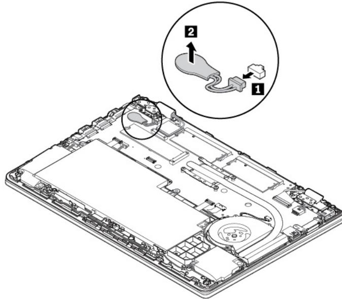
6. Setzen Sie die neue Knopfzellenbatterie **1** ein und schließen Sie dann den Stecker **2** an.
