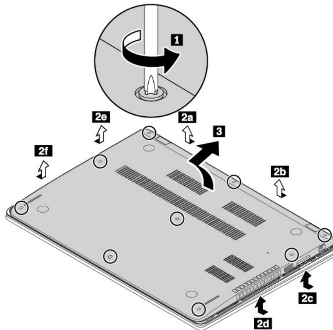
6. Montieren Sie die Baugruppe für die untere Abdeckung an der entsprechenden Position. Ziehen Sie dann die Schrauben fest, um die Baugruppe für die untere Abdeckung zu fixieren.
