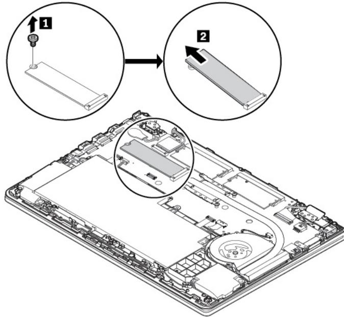
6. Setzen Sie das neue M.2-Solid-State-Laufwerk in einem Winkel von ca. 20 Grad in den Steckplatz ein **1**. Drehen Sie das M.2 Solid-State-Laufwerk nach unten **2** und ziehen Sie die Schraube an, um das M.2 Solid-State-Laufwerk zu sichern **3**.
