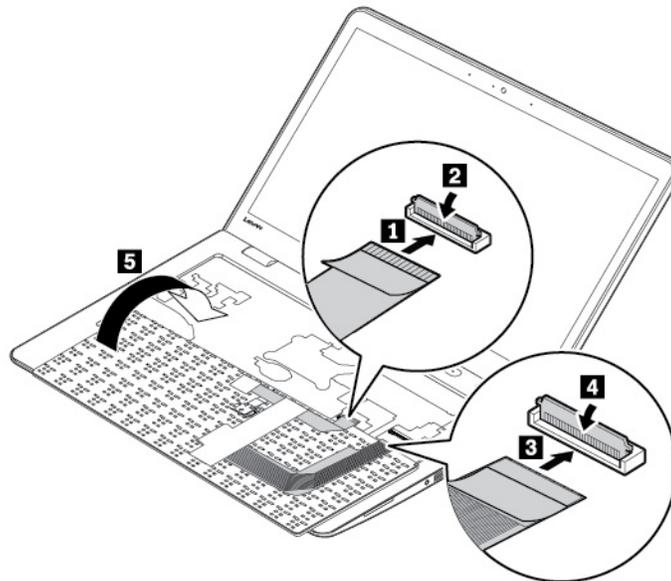
2. Setzen Sie die Tastatur wie abgebildet in die Tastaturblende ein. Stellen Sie sicher, dass sich die vordere Kante der Tastatur (die zum Bildschirm weisende Kante) unter dem Rahmen der Tastaturblende befindet.
