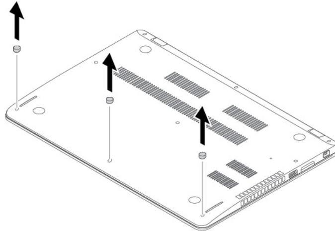
5. Lösen Sie die Schrauben, mit denen die Baugruppe für die untere Abdeckung gesichert ist. Heben Sie die Verriegelungen ab, wie abgebildet. Entfernen Sie dann die Baugruppe für die untere Abdeckung.
