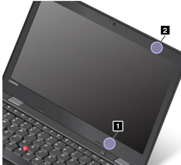
**1** Antenne für drahtlose LAN-Verbindungen (Hilfsantenne)
