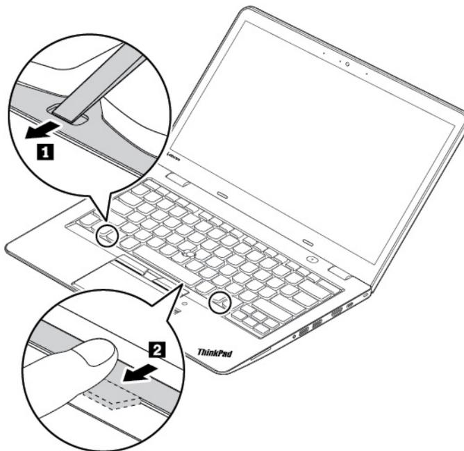
6. Führen Sie das flache Ende des Werkzeugs wie in der Abbildung gezeigt an den Seiten der Tastatur ein und schieben Sie den Tastaturrahmen nach hinten. Stellen Sie sicher, dass zwischen dem Tastaturrahmen und der Tastaturblende kein Spalt ist.
