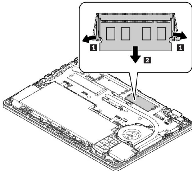
6. Setzen Sie das neue Speichermodul in einem Winkel von etwa 20 Grad in den Speichersteckplatz ein **1**. Klappen Sie das Speichermodul nach unten, bis es hörbar einrastet **2**. Stellen Sie sicher, dass das Speichermodul fest im Speichersteckplatz installiert ist und nur schwer bewegt werden kann.
