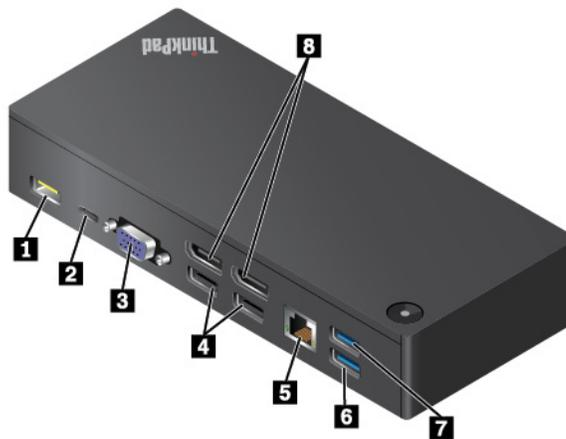
**1 Netzteilanschluss:** Schließen Sie das Netzteil an.
