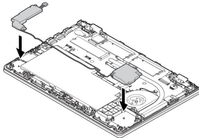
8. Bringen Sie dann die beiden Schrauben an, um die Lautsprechereinheit zu befestigen **1**. Schließen Sie den Stecker wieder an **2**.
