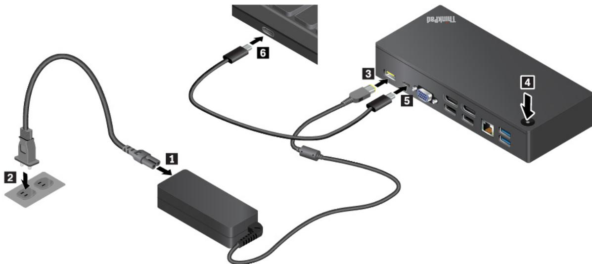
1. Schließen Sie das Netzkabel an das Netzteil an **1**.
