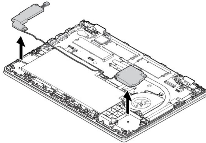
7. Montieren Sie die neue Lautsprechereinheit an der entsprechenden Position.
