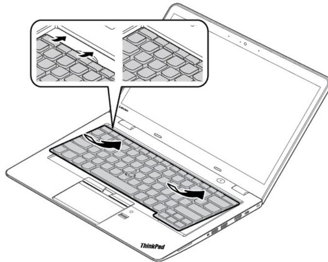
3. Stellen Sie sicher, dass die Schraubenköpfe vollständig freigelegt sind. Sollte das nicht der Fall sein, legen Sie die Schraubenköpfe frei, indem Sie den Tastaturrahmen in Richtung Bildschirm schieben.
