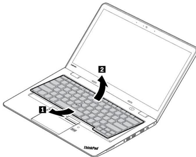
5. Legen Sie die Tastatur auf die Handablage und ziehen Sie die Stecker ab. Anschließend entfernen Sie die Tastatur.
